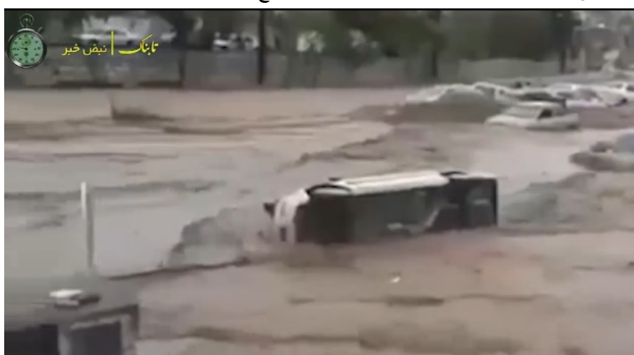
شکل ۱۱ از روی این عکس و عکس های مشابه دیگر ارتفاع سیلاب در کف بلوار ۰.۷۵ متر برآورد شده است
