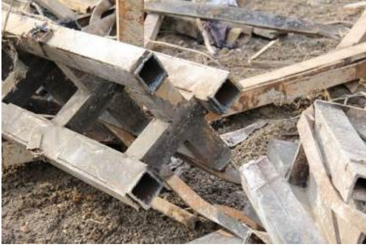
شکل ۴-۹- مقطع ستون‌های فولادی برج پلاسکو
